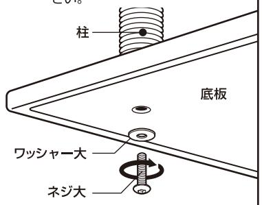
3 柱とスペーサー、柱をジョイントネジを使って、図のようにつなぎ合わせてください。
