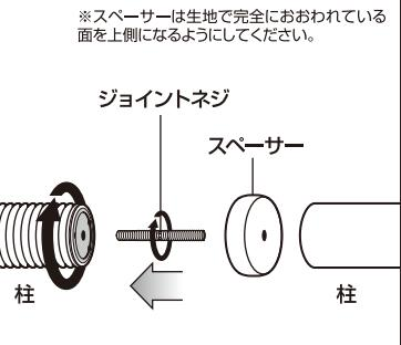
4 お魚板にジョイントネジを使って柱と柱をしっかりと固定してください。お魚板の頭の穴に柱を六角レンチを使ってネジ大でしっかりと固定してください。
