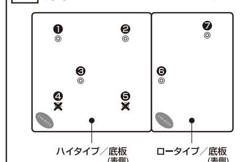
2 底板の裏側から柱を六角レンチを使ってネジ大にワッシャー大を取り付けたうえでしっかりと固定してください。
