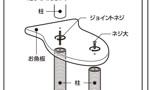
5 ベッドにジョイントネジを使って柱と柱をしっかりと固定してください。
