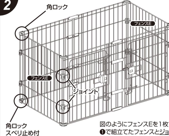
図のようにフェンスEを1枚ずつセットし
