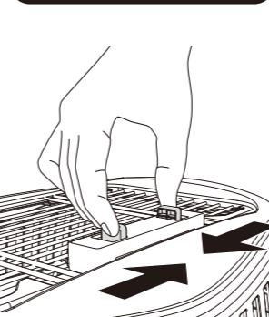
図のように、ドアのロックをつまみながら開閉します。
