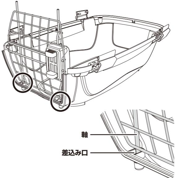
図のように、下本体に正面ドアを取り付けてください。
