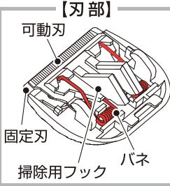
3.掃除用フックを押して、固定刃と可動刃の間を開き、掃除用ブラシで毛クズや汚れを落とす。
