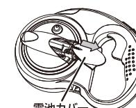
②電池ボックスの奥側が+極になるように単4形乾電池を入れてください。最後に電池カバーを元に戻してください。
